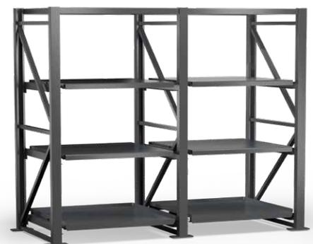
**Étagères pour charges lourdes** de conception particulièrement solide avec une capacité de charge maximale de 9 tonnes par unité de rayonnage et 1000kg par cadre extensible ou fixe, dotées d'une fermeture sûre et toujours extensibles par pas de 100mm
